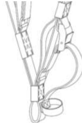
Fig. 6: Vue globale des élévateurs avec le Trim attaché entre le mousqueton et la poulie de frein
